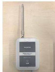
手のひらサイズの電池式IoT端末
